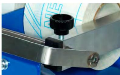
**1.** Rollenhalterung mit der Schraube lösen und nach außen verschieben.
