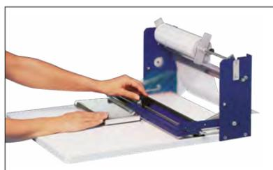
**4.** Folie leicht straff ziehen und mit dem angebauten Messer abschneiden.
