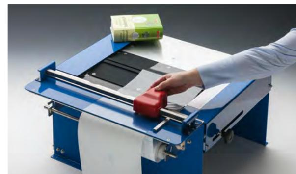
**7.** Schneiden Sie die filmolux®-Folie mithilfe des Schneidkopfes ab.
