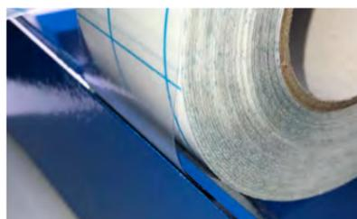
**2.** Rolle (Anfang nach hinten) in den TA3 einlegen und das Silikonpapier ein Stück lösen. Die Folie mit der klebenden Seite nach unten in den Schlitz (Trennvorrichtung) hinten am TA3 einfädeln.
